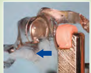
Einsetzen der Kappe in das EDELSTAHLGEHÄUSE von der Seite
